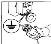
Корпус генератора должен быть заземлен в соответствии с местными правилами устройства электроустановок. Следует удостовериться, что исправности цепей заземления.
