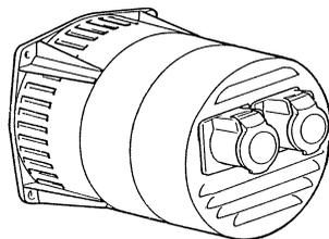
Корпус генератора, изготовленный из высокопрочного алюминиевого сплава, предусматривает консольную установку передним фланцем на приводной двигатель. Вал генератора из стали С45 оснащен вентилятором для охлаждения обмоток.
