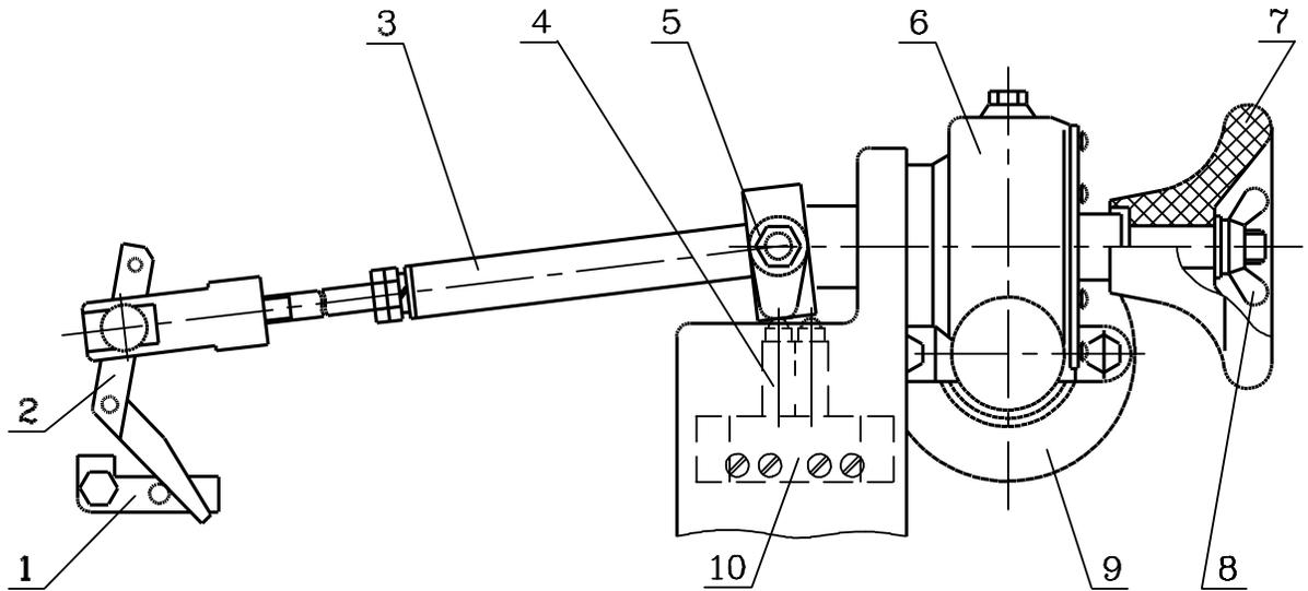
Рис.2 Механизм управления регулятором
