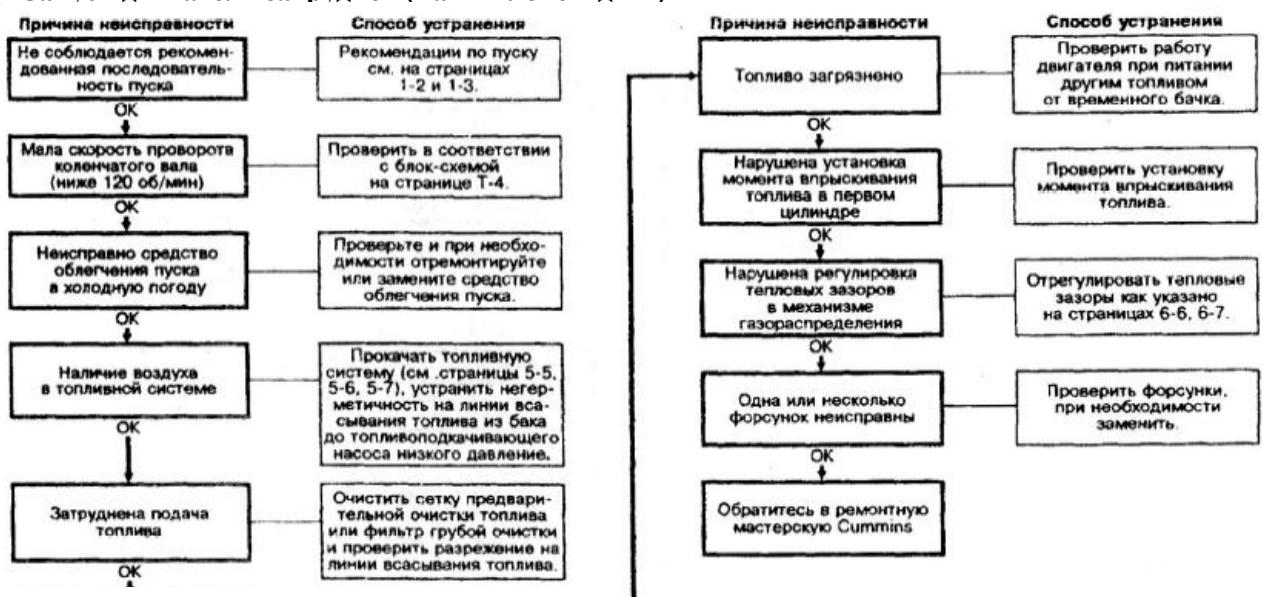
**Двигатель не пускается (коленчатый вал проворачивается стартером, но на выхлопе дым не наблюдается)**
