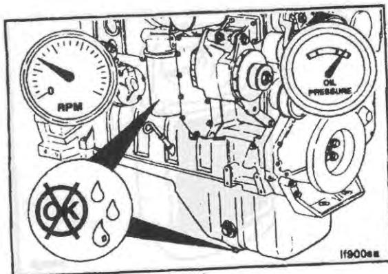
Погоняйте двигатель на холостом ходу, чтобы выявить возможные утечки/протечки масла и сливной пробки.
