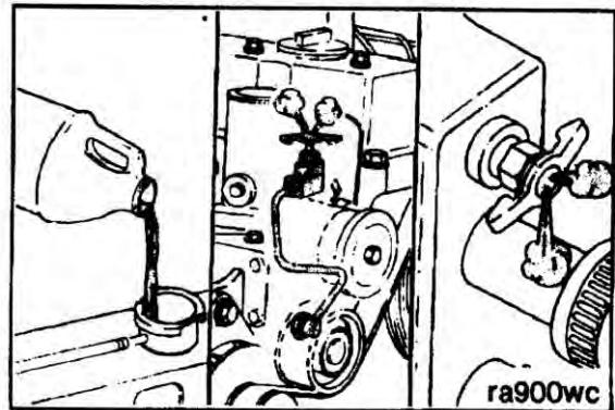
Погоняйте двигатель в течение 5 минут при температуре охладителя выше  $80^{\circ}\text{C}$ .
