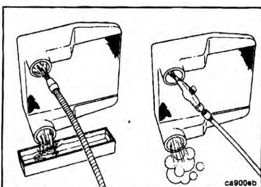
После полной очистки САС чистящим средством, тщательно промойте емкость мыльным раствором, а затем чистой водой. Высушите сжатым воздухом.
