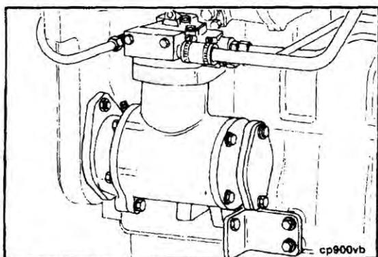
Прим.: во всех воздушных компрессорах на кольцах цилиндров и движущихся частях имеется небольшое количество масла. Если оно подвергается воздействию воздуха длительное время, оно загрязняется. Если не следить за состоянием компрессоров, кольца цилиндров будут подвергаться высоким рабочим температурам и не будут плотно прилегать к стенкам цилиндров.
