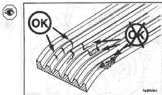
Допускается наличие поперечных трещин. НЕ допускается наличие продольных трещин и выщербин!
