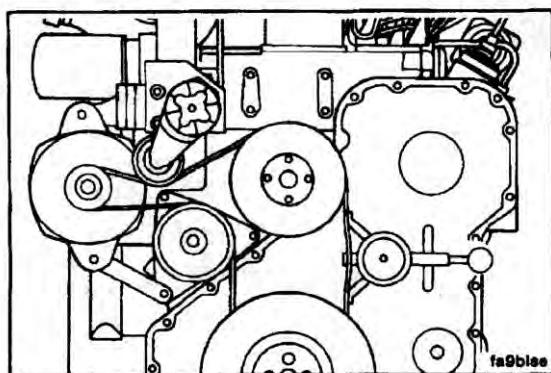
Можно проверить натяжение стандартным прибором Cummins ST-1293.
