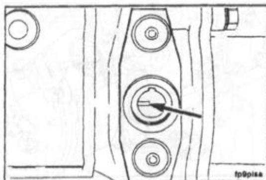
Если зуб установки момента впрыскивания топлива не совпадает с отверстием фиксатора, то нужно вращать вал ТНВД до тех пор, пока зуб не установится напротив отверстия.
