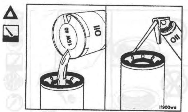
Прим.: на масляном фильтре LF3000 две уплотнительных прокладки. Смажьте обе прокладки.
