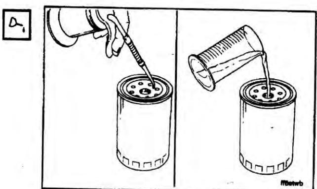
Заполните новый фильтр/фильтры чистым топливом и смажьте кольцевую прокладку чистым сма佐чным маслом 15W-40.
