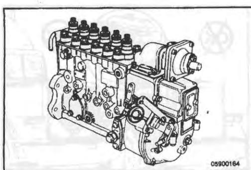
Насосы RQV – K Bosch P7100 предназначены для двигателей серии L для автомобилей.
