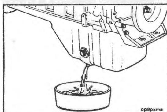
Погоняйте двигатель, пока температура воды не будет  $60^{\circ}\text{C}$ . Отключите двигатель. Снимите сливную крышку.
