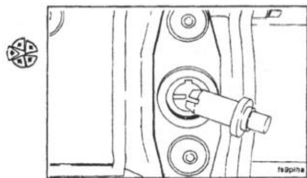
Установите фиксатор на место и закройте отверстие заглушкой. Убедитесь в том, что уплотнительное кольцо (A) отверстия для подвода масла и уплотнение (B) установлены на место и не имеют повреждений.
