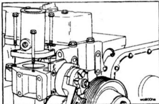
Снимите коробку термостата в сборе с натяжным устройством.
