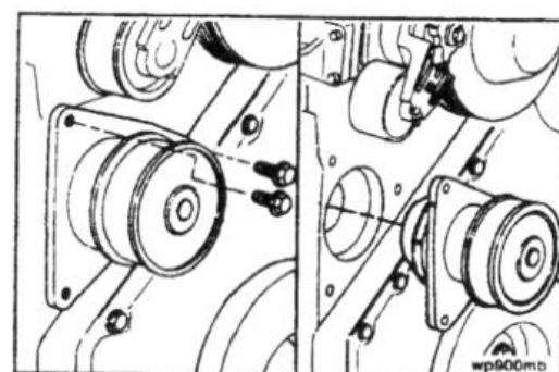
Очистите поверхность в блоке цилиндров, с которой контактирует уплотнение водяного насоса.
