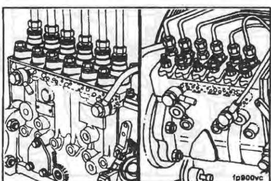
Стравливание воздуха, попадающего в топливную систему при замене фильтров, производится автоматически, если замена фильтров производится по инструкции.
