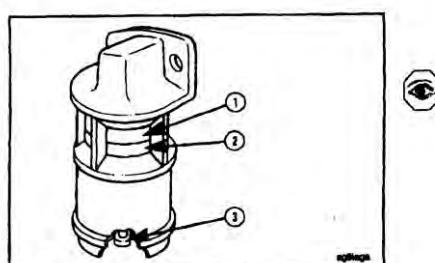
Заменяйте фильтрующий элемент, когда красный индикаторный флагок (2) находится в окошечке (1) в поднятом положении. После проведения обслуживания нажмите на кнопку (3) на конце индикатора.
