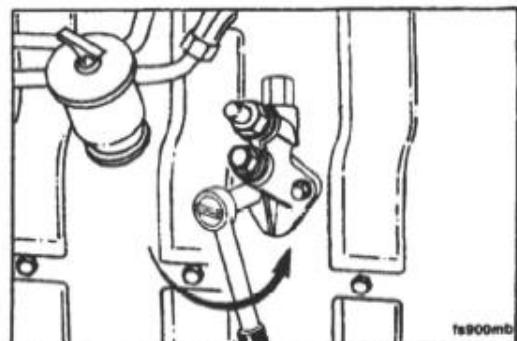
Пустите двигатель и поочередно удалите воздух из топливопроводов, пока двигатель не заработает плавно.
