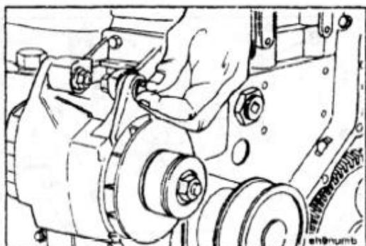
Установите генератор на кронштейн и закрепите его установочными болтами, но не затягивайте их.
