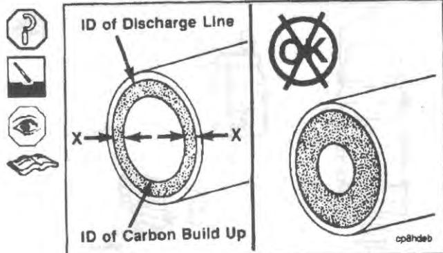
Проверьте весь воздухопровод до первой емкости, пока толщина  $X+X$  не будет меньше 2 мм. Замените или почистите чрезмерно загрязненные воздухопроводы.
