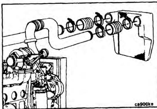
Если с двигателем применяется турбонаддув, и если в воздушную систему принудительного охлаждения попало масло или мусор, прочистите систему.
