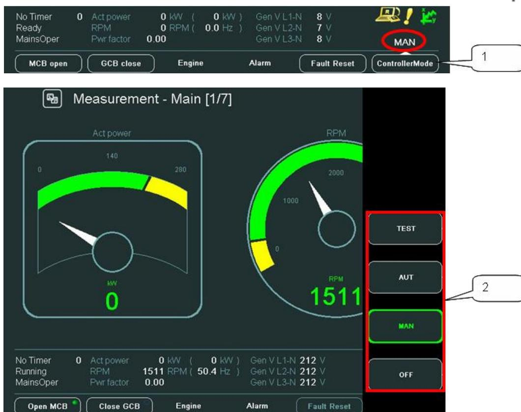
Рис. 7 – Изменение режима работы контроллера
