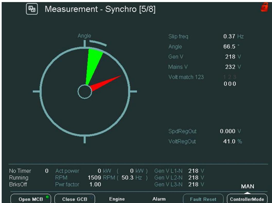
Рис. 20 – Экран синхроскопа
